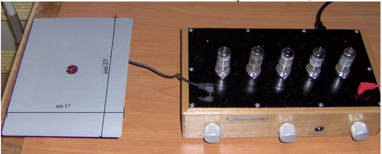
Particolare del mobile con antenna volume (piastra d'alluminio)
